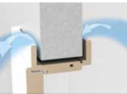
Nachströmung abgesaugter Luft innerhalb der Wohnung
